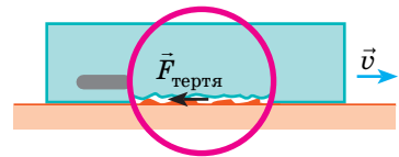
Рис. 21.7. Виникнення сили тертя пов'язане з наявністю нерівностей на поверхнях дотичних тіл
