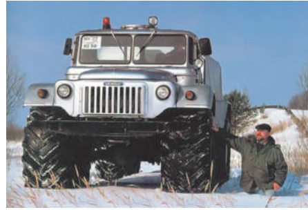
Рис. 22.5. Людина провалилася в сніг, а всюдихід залишився на його поверхні
