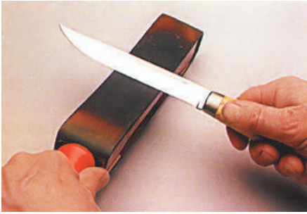
Рис. 22.4. Щоб прикладати менше зусиль під час роботи з деякими інструментами, їх нагострюють
