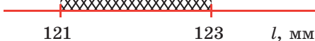
Рис. 5.2. Абсолютна похибка вимірювання визначає інтервал, у якому міститься істинне значення вимірюваної величини
