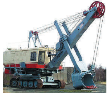
Рис. 35.2. Нерухомі блоки, які є в конструкції кар'єрних екскаваторів, дозволяють змінювати напрямок дії сил під будь-яким кутом
