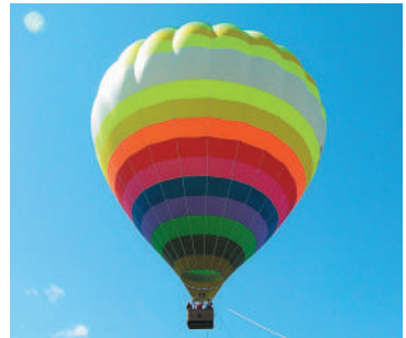
Рис. 29.3. Повітряні кулі, які здіймаються завдяки заповненню оболонки гарячим повітрям, і зараз називають монгольф'єрами (на честь братів Монгольф'є із Франції, які у XVIII ст. зробили цій винахід)
