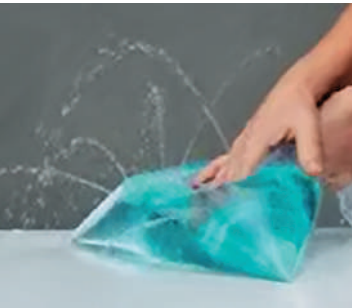
Рис. 23.5. Вода передає додатковий тиск у всі боки і внаслідок цього виходить із отворів у пакеті в усіх напрямках
