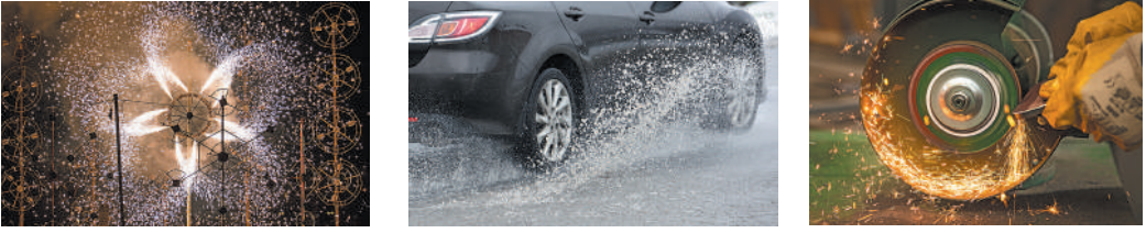
Рис. 8.2. Швидкості руху іскор феєрверка, бризок з-під коліс автомобіля, металевих ошурок напрямлені по дотичній до кола. Саме в цьому напрямку частинки продовжують свій рух після відриву
