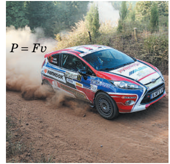
Рис. 15.3. Коли для руху автомобіля потрібна більша сила тяги, водій переходить на меншу швидкість або натискає на газ, збільшуючи таким чином потужність двигуна
