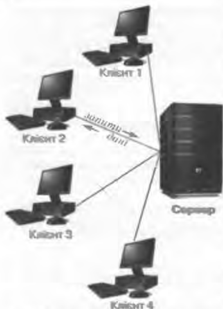
Рис. 3.19. Схема використання бази даних за клієнт-серверною технологією
