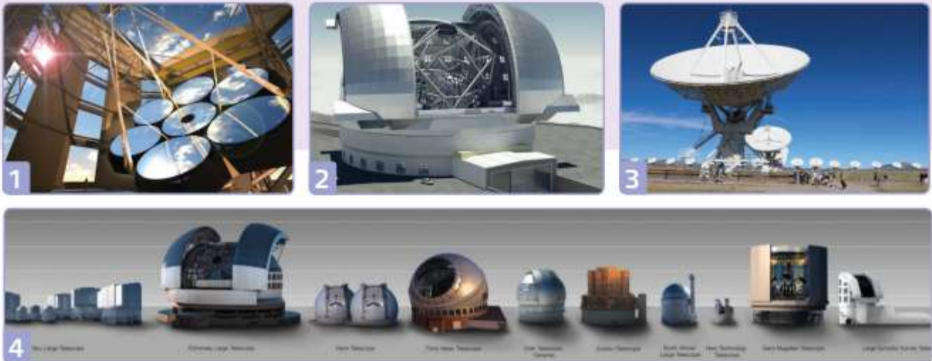
Мал. 137: 1 — Великий Магелановий телескоп (7 дзеркал діаметром 8,4* м); 2 — Дуже Великий Телескоп E-ELT (дзеркало діаметром 39* м); 3 — Дуже великий масив радіотелескопів ім. Карла Янського; 4 — порівняльні розміри телескопів
